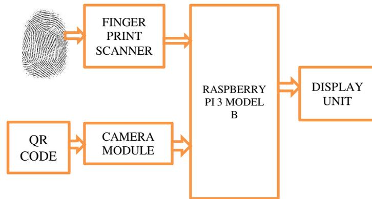
FIG 4.1 BLOCK DIAGRAM FOR AUTHENTICATION
